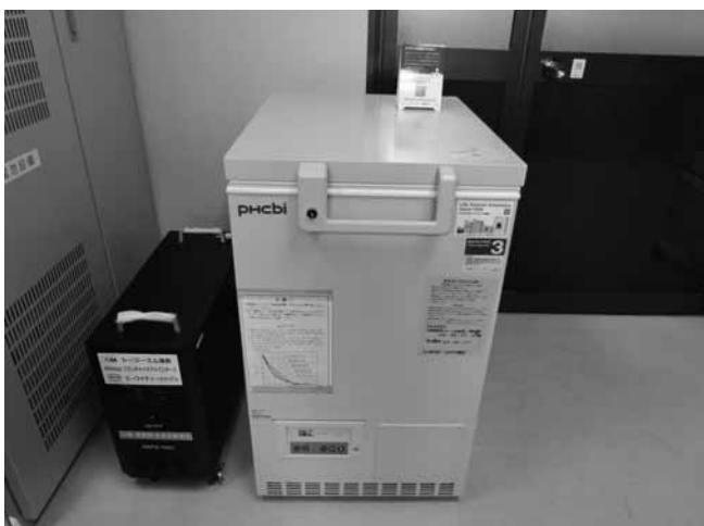
保健センターに設置された超低温フリーザー
